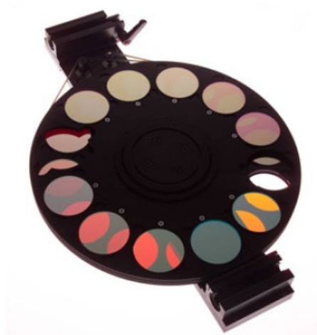
Fig. 2 – Mecanismo da Roda de Filtros de Emissão
